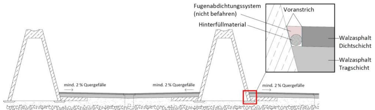
**Abb. 8:** Asphalt - Betonfertigteil (schräge Wand)
