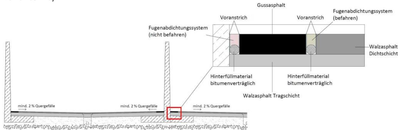
**Abb. 6:** Asphalt - Betonfertigteile (gerade Wand) mit Ortbetonfuß
