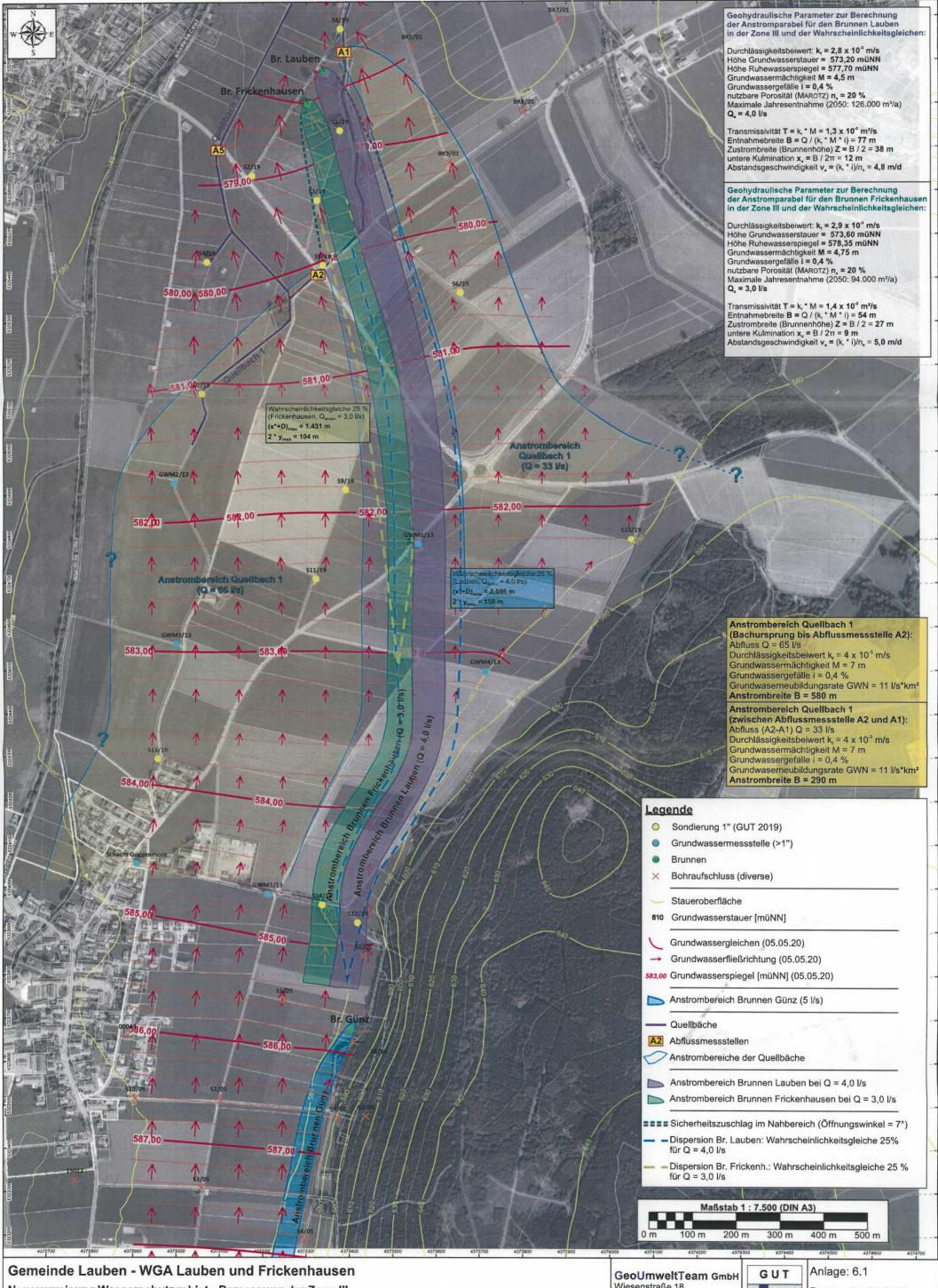
Neuausweisung Wasserschutzgebiet - Bemessung der Zone III
